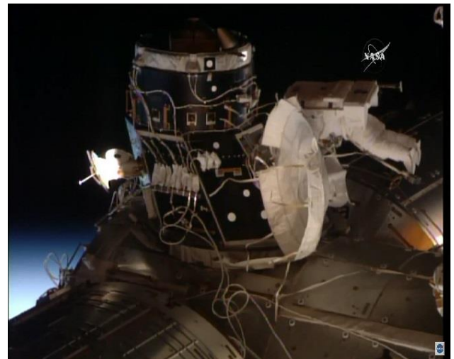
Dépose de la bâche du PMA-3.
