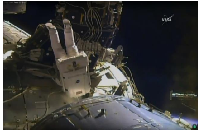
Jack installation de la protection anti-micrométéorite sur la base du PMA-3.
