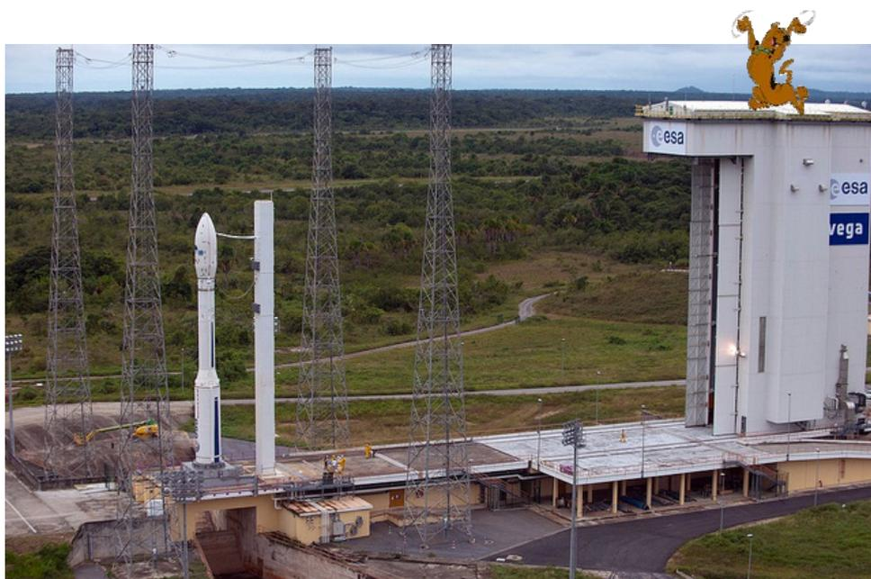
Contrairement à ce qui se passe pour Ariane 5, ce nouveau lanceur Véga est assemblé directement sur le pas de tir dans une *tour de montage* mobile qui le protège des intempéries. Cette tour dispose d'un pont roulant (le **treuil** disponible dans mon add-on) d'une capacité de levage de 40 tonnes permettant de hisser les différents composants du lanceur.
